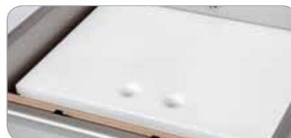
Keine teuren Extras: Einlegeplatten und Flüssigkeitseinsatz sind unverzichtbare Helfer und bei jedem Gerät im Lieferumfang enthalten. Einlegeplatten dienen dazu, die Kammerhöhe an das Produkt anzupassen. Dadurch wird das Kammervolumen „verringert“ und der Vakuumvorgang beschleunigt (bei MAP kleinerer Gasverbrauch). Der Flüssigkeitseinsatz ermöglicht das Vakuumieren von flüssigen Produkten. Er verhindert das Wegrutschen und Auslaufen von Flüssigkeiten aus dem Beutel.
