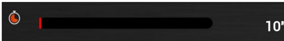
Durch Touchscreen einstellbar. Bei rechts scrollen, nimmt der Wert zu, bei links scrollen nimmt er ab. Für eine genaue Einstellung [+] drücken, um den Wert um eine Einheit zu erhöhen oder [-], um den Wert um eine Einheit zu verringern.
