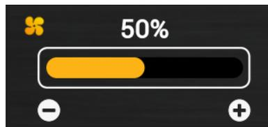
Durch Touchscreen einstellbar. Bei rechts scrollen, nimmt der Wert zu, bei links scrollen nimmt er ab. Für eine genaue Einstellung [+] drücken, um den Wert um eine Einheit zu erhöhen oder [-], um den Wert um eine Einheit zu verringern.
