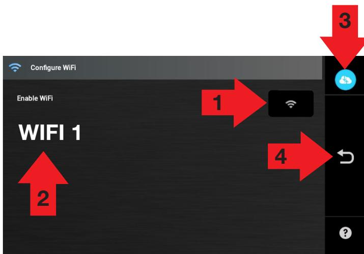
Das Symbol **(1)** drücken und auf ON stellen, um die WLAN-Verbindung von Oracle zu aktivieren.
