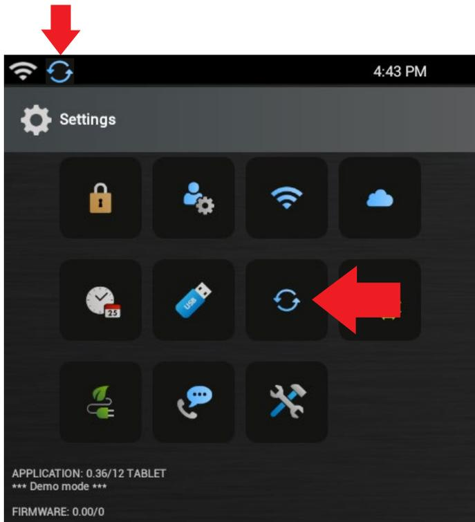
Die Verfügbarkeit einer Software-Aktualisierung wird durch ein Symbol im Bereich der Mitteilungen oben links hervorgehoben.
