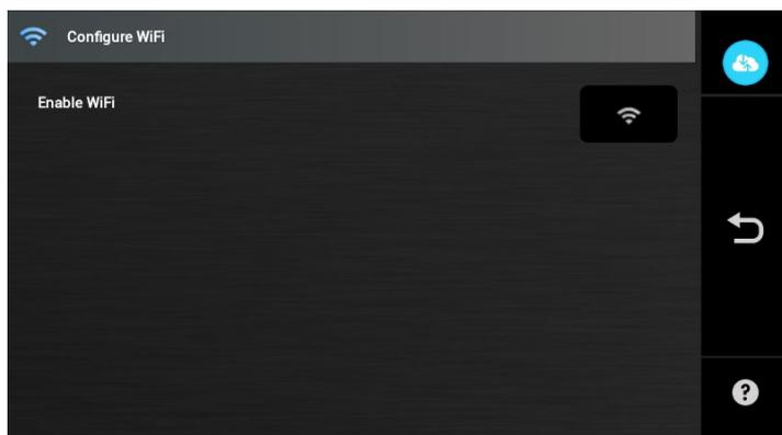
Das Symbol **“WI-FI freigeben”** zum Zugang zu den verfügbaren WI-FI-Netzen drücken.
