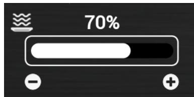
Durch Touchscreen einstellbar. Bei rechts scrollen, nimmt der Wert zu, bei links scrollen nimmt er ab. Für eine genaue Einstellung [+] drücken, um den Wert um eine Einheit zu erhöhen oder [-], um den Wert um eine Einheit zu verringern.
