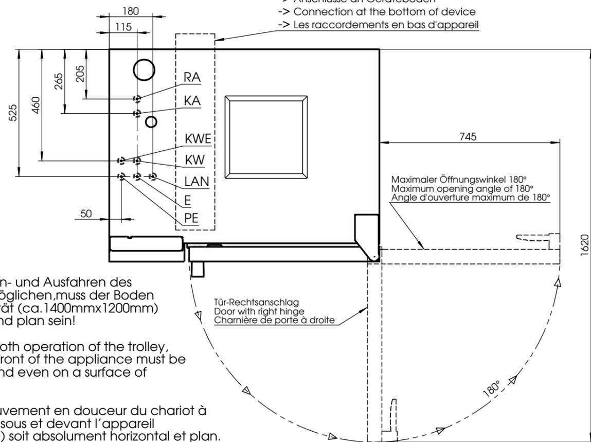
Um ein reibungsloses Ein- und Ausfahren des Hordenwagens zu ermöglichen, muss der Boden vor und unter dem Gerät (ca. 1400mmx1200mm) absolut waagrecht und plan sein!
