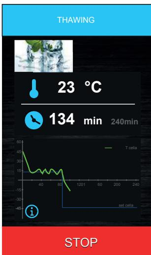
Das Ende des Auftauzyklus wird durch ein akustisches Signal angezeigt, danach startet die Maschine die Phase der Konservierung mit einer Temperatur von 3°C.
