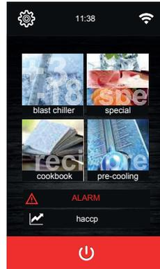
Bei der Einschaltung könnte der Fehler RTC, d.h. der Fehler der Uhr vorhanden sein; ggf. muss das Datum und die Uhrzeit über die Bildschirmseite Einstellungen eingestellt werden.
