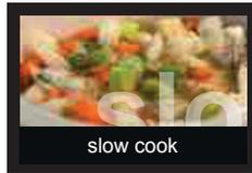
Der Druck auf dieses Fenster erlaubt die Wahl eines langsamen Garens. Nach der Wahl der Funktion "Langsames Garen" erscheint eine Bildschirmseite, in der es möglich ist, die bezüglichen Setpoint zu visualisieren und zu ändern, und die Ausführung der temperaturgesteuerten oder zeitgesteuerten Einstellung zu entscheiden; während der Ausführung des Zyklus ist es nicht möglich, den Setpoint zu ändern.
