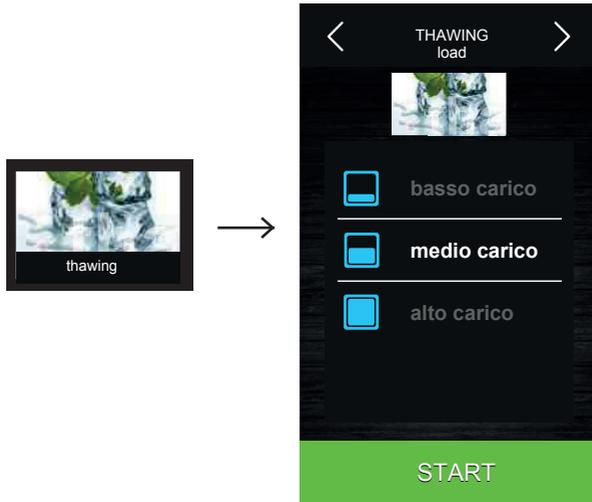
Der Druck auf dieses Fenster erlaubt die Wahl eines Auftauzyklus, der je nach aufzutauender Produktmenge, die in die Maschine eingeführt wurde, im Verhältnis zur vom Hersteller erklärten Höchstmenge verwaltet wird. Es ist für den Bediener möglich, 3 Füllstände an aufzutauender Ladung anzugeben. Je nach gewähltem Füllstand startet der Schockfroster einen zeitgesteuerten Zyklus und mit unterschiedlicher Zellentemperatur, wie in der folgenden Tabelle angegeben:
