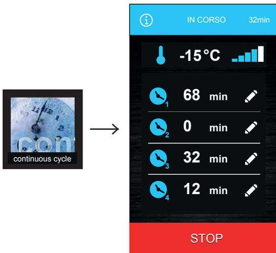
Der Druck auf dieses Fenster erlaubt, einen Zyklus in Modalität Multi-Timer zu wählen. Nach der Wahl des Zyklus öffnet sich eine Bildschirmseite, in der es möglich ist, die gewünschte Zellentemperatur für den Dauerzyklus einzustellen (Preset).
